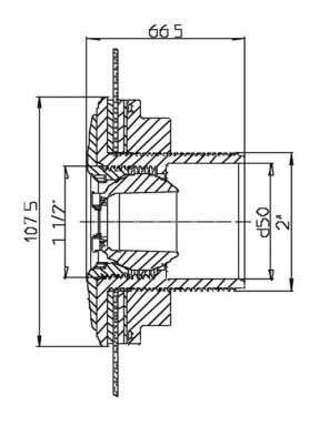
Входная насадка Ocean® для бассейнов из полиэстера ABS черная в комплекте (уплотнительный комплект и зажимная гайка)
