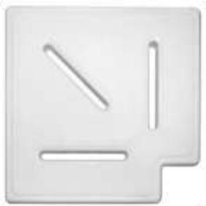
Угловой элемент 90° использующийся для переливных каналов от компании Requa представляет собой угловую решетку, выполненную из высококачественного полиэстера и стекловолокна белого цвета. Данный элемент предназначен для накрытия переливного желоба и соединения переливных решеток в углах бассейна. Верхняя часть углового элемента имеет противоскользкую поверхность.
