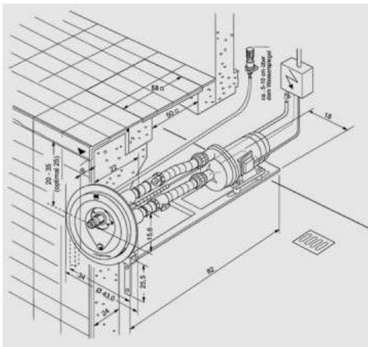
В комплекте поставляется комплект обвязки, блок пневмупуска и насос производительностью 47 м<sup>3</sup>/ч
