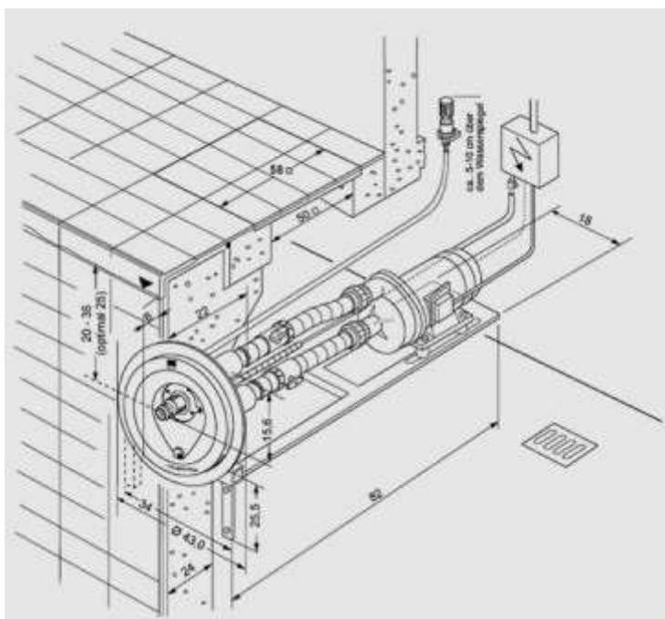
В комплекте поставляется комплект обвязки, блок пневмупуска и насос производительностью 60 м<sup>3</sup>/ч
